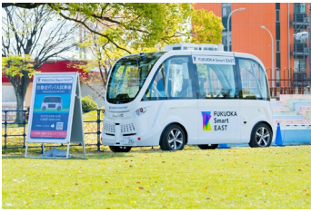
ハンドルのない自動運転小型バス
